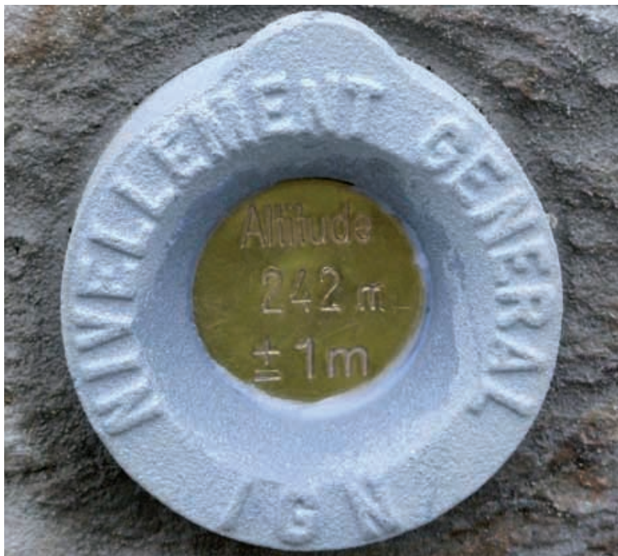
Figure 1. Repère de nivellement de type M (médaille) - L'altitude d'un repère de nivellement est susceptible d'évoluer au cours du temps. Pour éviter de changer la plaquette altitudinale à chaque opération de nivellement et inciter à utiliser l'altitude la plus à jour, disponible gratuitement sur le site www.ign.fr , l'altitude marquée sur le repère est arrondie au mètre.
