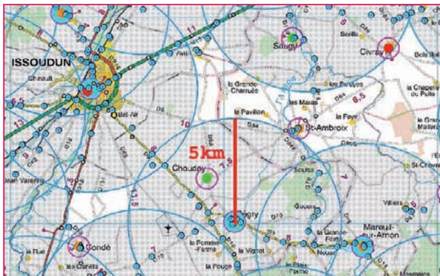
Figure 3 : Triplets dans la région d'Issoudun (Indre) - Sur l'extrait de carte ci-dessus, les repères de nivellement sont figurés par de petits disques bleus. A l'issue du contrôle réalisé en 2000, l'IGN a constaté que le nombre de repères était insuffisant dans le bourg de Saint-Ambroix (Cher) et que la petite ville de Civray, dont la population est supérieure à 1000 habitants, se trouvait en limite de zone d'influence d'un triplet. Deux nouveaux triplets ont donc été créés dans ces agglomérations.
