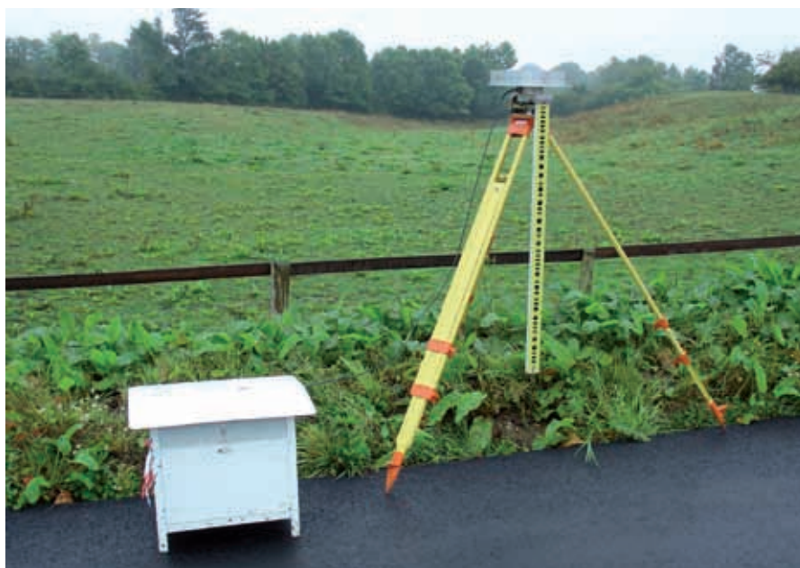
Figure 4. Matériel utilisé dans le cadre des travaux ERNIT, antenne GNSS équipée d'une mire de nivellement à codes-barres.
