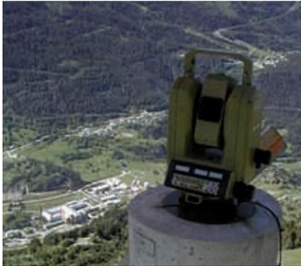
Figure 18. Tachéomètre sur pilier P1.
