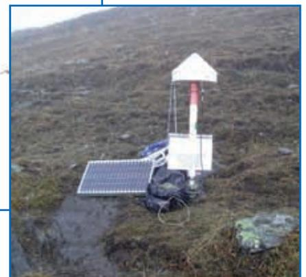
Figure 7. Repère GPS équipé d'une antenne Choke Ring.
