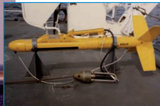
Figure 5. Le sondeur latéral Edgerton Mark 1B mis en œuvre par l'Astrolabe.
