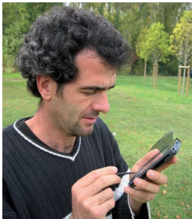
Figure 2. Illustration de la saisie à l'aide d'un système composé de l'ordinateur de poche HP Ipaq, du GPS Tomtom et du SIG nomade ArcPad, ESRI.
