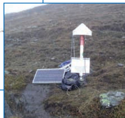
Figure 7. Repère GPS équipé d'une antenne Choke Ring.
