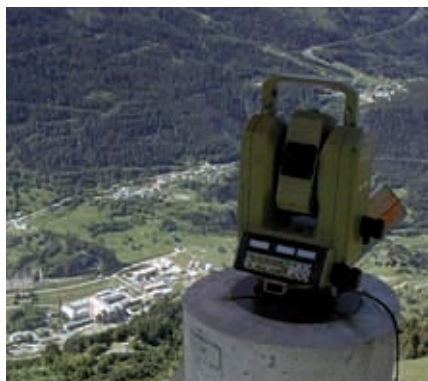
Figure 18. Tachéomètre sur pilier P1.
