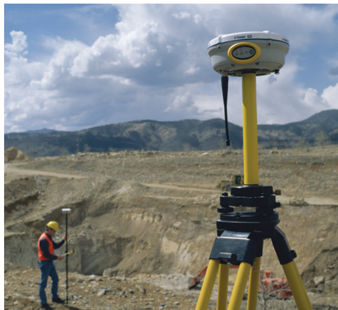
Base GPS Trimble R8 émettant les corrections par radio, 100% sans câble
