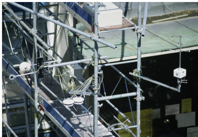
▲ Figure 2 : Appareils de mesures installés sur l'échafaudage de la rue de l'Argonne.
