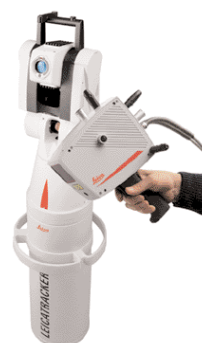
Laser de poursuite LEICA LTD800 et le scanner T-Scan.
