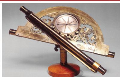
Graphomètres à lunettes et échelles transversales
