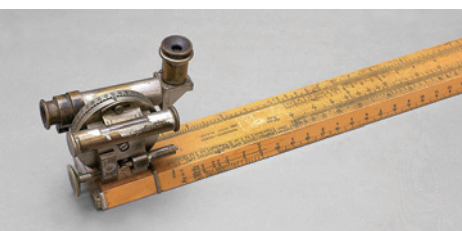
Règle à éclimètre "type Goulier"
