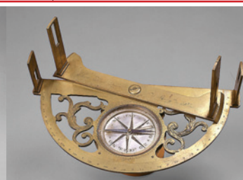
Graphomètre à pinnules et 2 verniers
