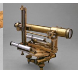
Tachéomètre "type Sanguet"
