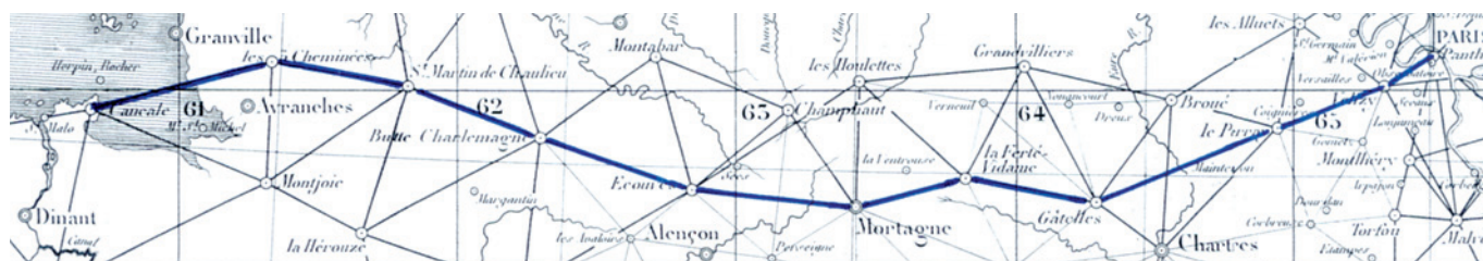
La polygonale du nivellement géodésique à visées réciproques et simultanées entre Cancale et Paris
