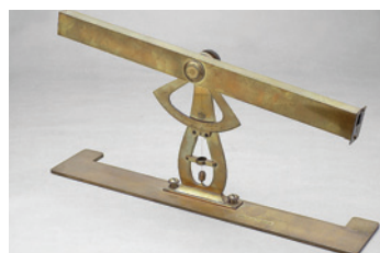
Alidade nivelatrice à perpendicule (fil à plomb)
