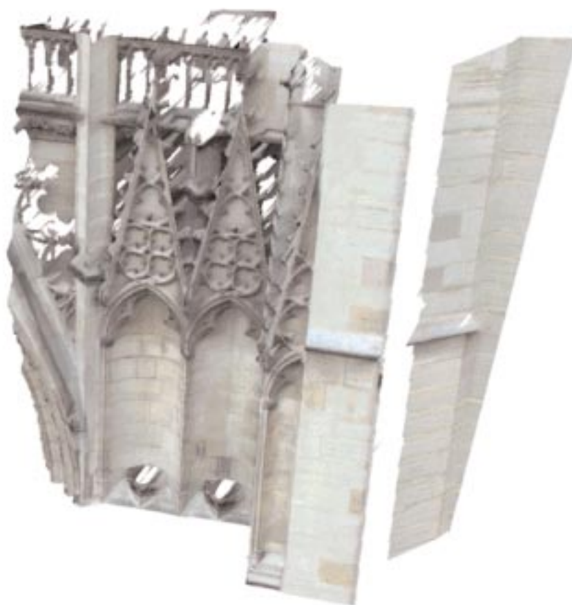
Figure 3 : Projection de l'image haute résolution sur le nuage de points triangulé.
