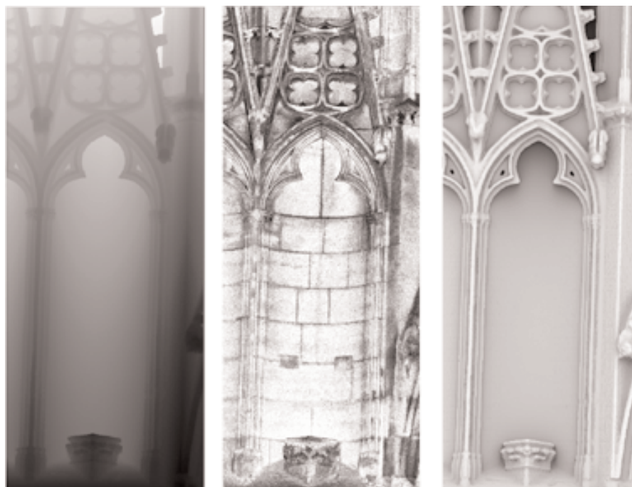
Figure 1 : Images calculées à partir des informations collectées par le scanner. Image de profondeur (gauche), image d'intensité et d'ombrage (droite).
