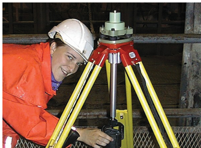
Figure 3. Réflecteur monté sous le trépied
