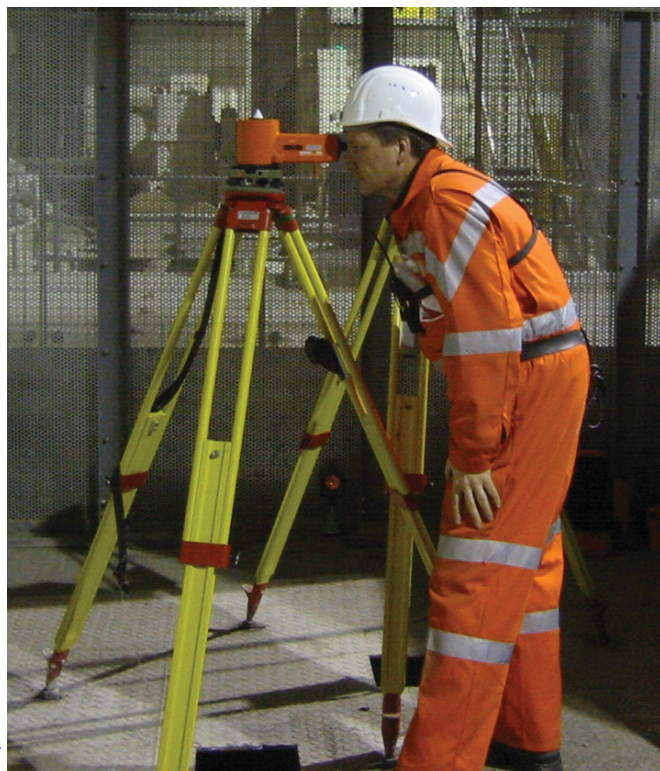
Figure 2. Lunette nadirale montée sur trépied
