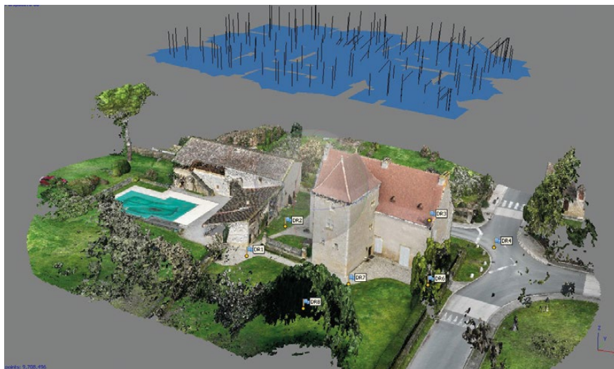
Figure 10. Nuage de points dense dans Metashape obtenu à partir de photographies prises par drone à Trémolat (Dordogne).
