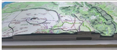
Figure 12. Carte en relief après empilement des couches de support.
