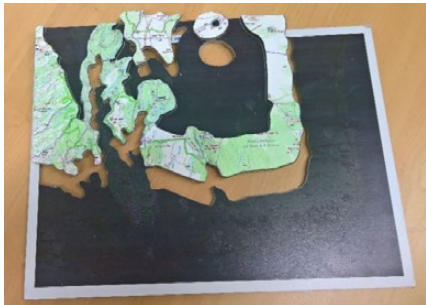
Figure 10. Séparation des couches paires et impaires après impression.
