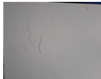
Figure 7. Prédécoupe par cutter de la couche paire.
