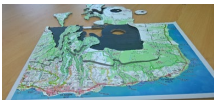
Figure 11. Montage d'empilement des couches paires et impaires pour créer la carte du relief sans limitation de hauteur.
