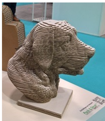
Figure 2. Stratoconception® de la société CIRTES pour réaliser une tête de chien en 3D avec des couches de carton.
