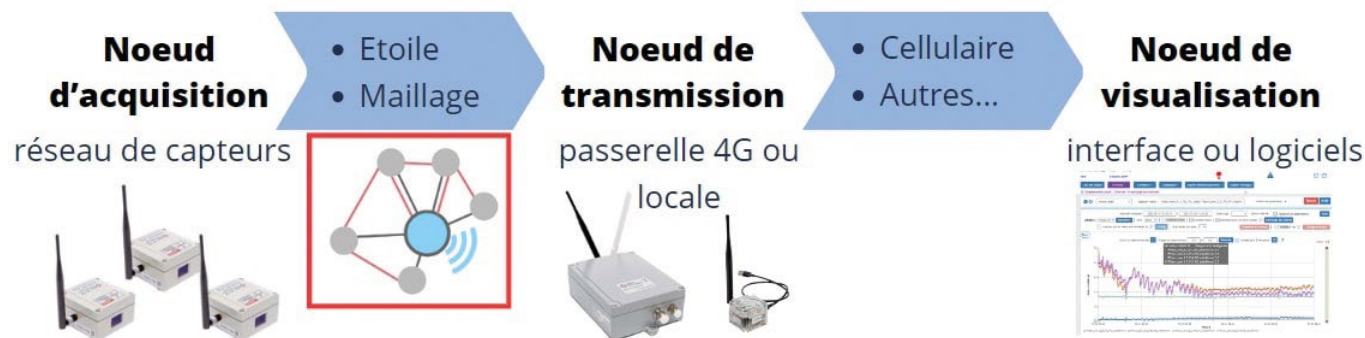
Figure 1. Schéma d'un réseau IoT dédié aux capteurs testés.
