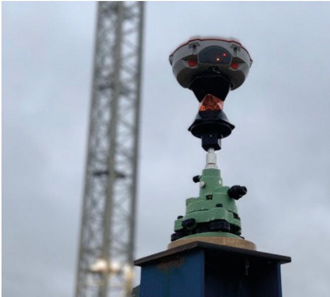
Figure 8. Un exemple de collocation d'un SinoGNSS T300 RTK et prisme à 360°.
