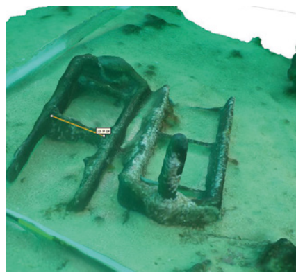
Figure 13 et 14. Relevé photogrammétrique du femlot et de l'aiguillot avec prise de mesure de l'épaisseur du safran.
