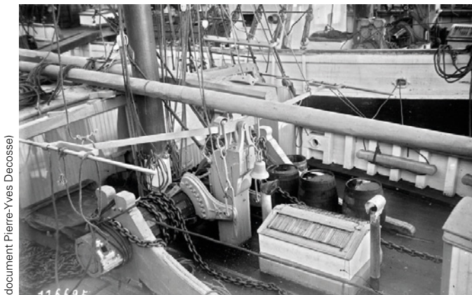
Figure 6. Guindeau à brimbale sur un navire terre-neuvier.
