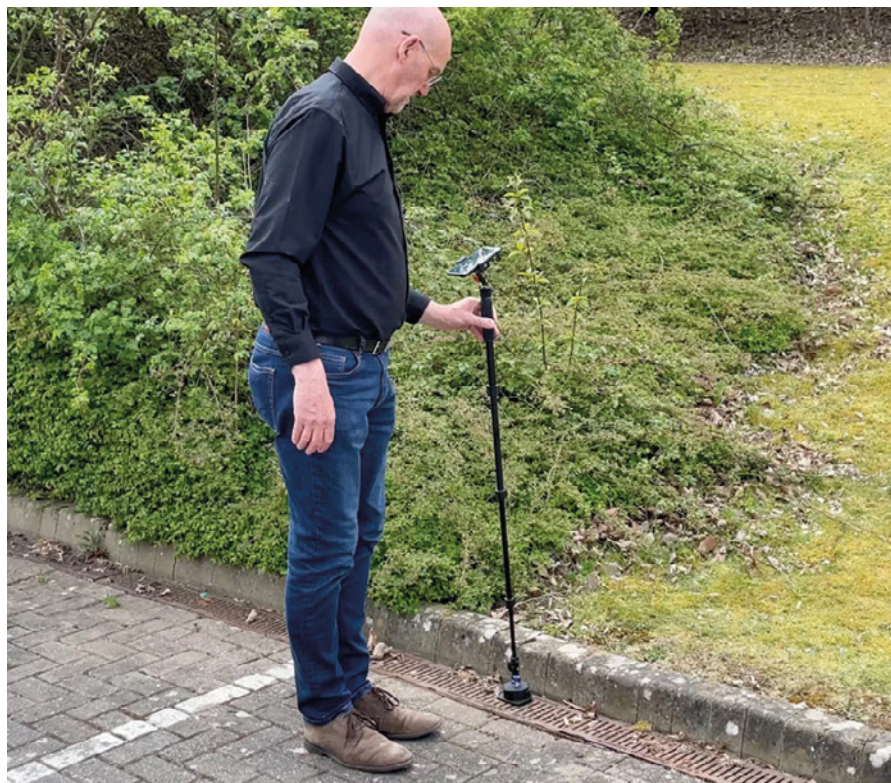
Figure 2. Moasure® ONE™, un outil de mesure basé sur le mouvement.
