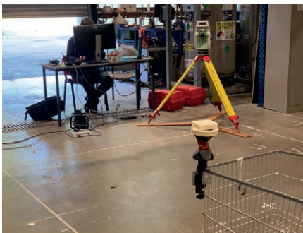
Figure 3. Détermination des coordonnées 3D des ancrés en utilisant une station totale permettant la mesure de distance sans réflecteur.
