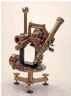
Figures 5. Théodolite magnétique Brunner. Théodolite en station dans l'île Harry.
