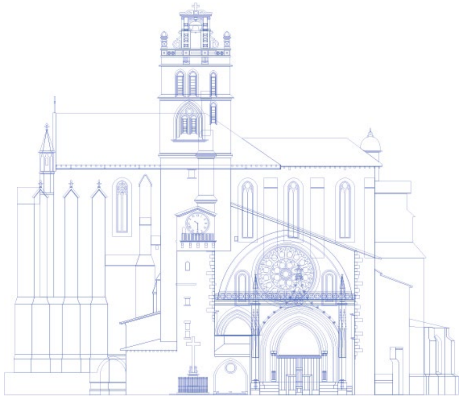
Figure 7. Dessin de la façade de la cathédrale Saint-Étienne de Toulouse à partir du nuage de points géoréférencés réalisé par les équipes de Novatlas.
