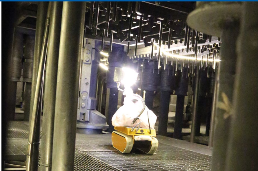
Figure 2. Numérisation SCAN 3D sur char robotisé dans le réacteur de Brennilis en 2016 (à d.) et de Saint-Laurent-des-Eaux (en haut) en 2011.
