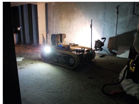
Figure 2. Numérisation SCAN 3D sur char robotisé dans le réacteur de Brennilis en 2016 (à d.) et de Saint-Laurent-des-Eaux (en haut) en 2011.
