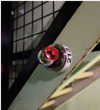
Figure 5. Utilisation de prismes CCR 1,5 pouce de métrologie à l'échelle du bâtiment entier pour le calcul précis du réseau de points 3D topographiques. À droite, un réseau de points au niveau 7 du BR2.
