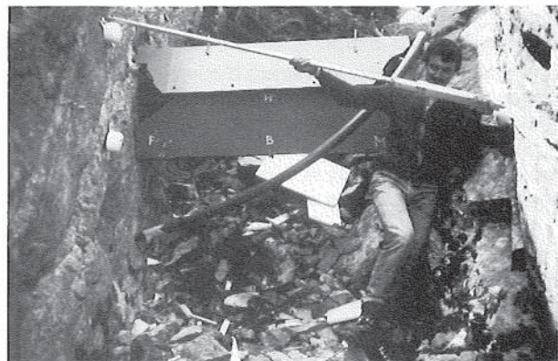
Fig. 5b — Mesure avec la canne de convergence (photographie)
