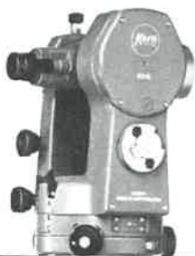
Kern K1-S. Théodolite d'ingénieur avec lecture sur échelles
