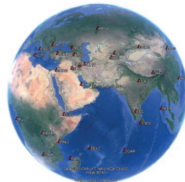
Figure 4. Stations IGS utilisées pour le rattachement du réseau géodésique à l'ITRF.
