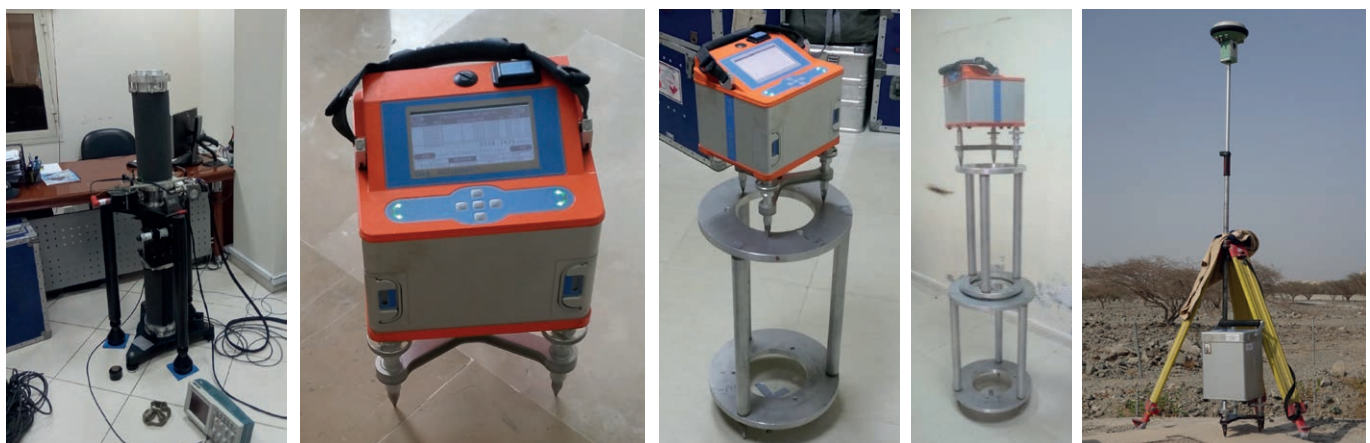
Figure 6. Levé de gravimétrie absolue et relative. À gauche : Gravimètre absolu FG5. Au centre : mesures CG6 du gradient vertical de gravité. À droite : GNSS et gravimétrie relative CG5 combinés.
