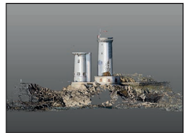
Nuage de points du Phare réalisé en 1h30 avec le scanner FARO S150
