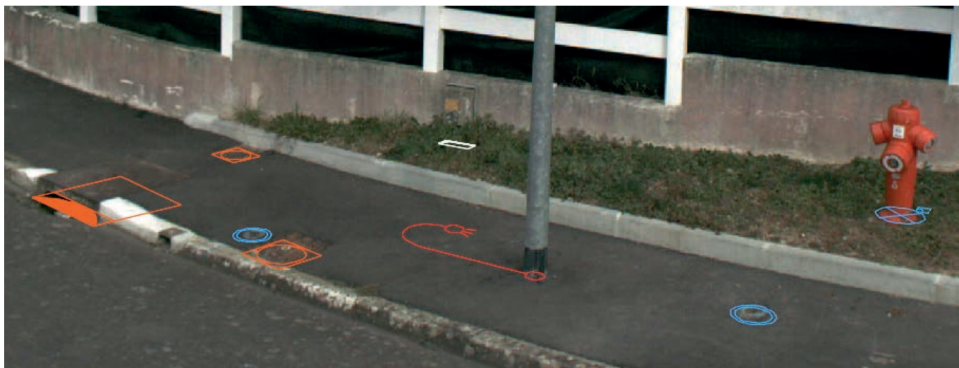
Figure 10. Exemple de projection automatique d'éléments du plan sur photographie
