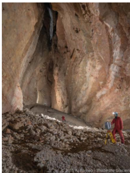
Figure 4. Relevé du fond du gouffre en 2015 avec le Leica HDS7000
