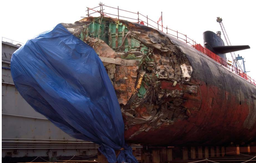
Figure 7. Dommages subis par le sous-marin USS San Francisco
