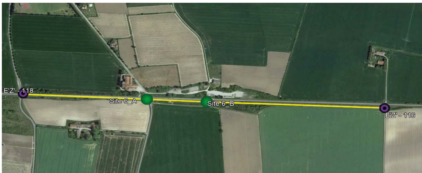
Figure 12. Cas d'un rattachement avec un simple cheminement encadré - les RN en violet, les points de canevas en vert
