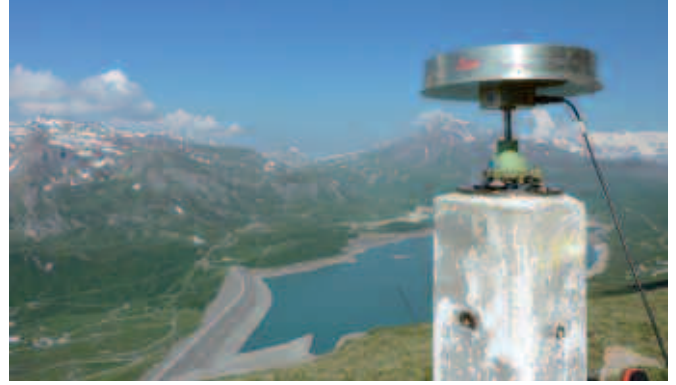
Figure 14. Auscultation par GPS statique d'un glissement de terrain
