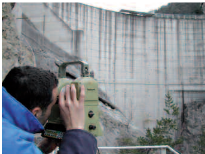
Figure 5. Auscultation topographique d'un barrage
